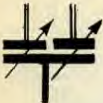
CONDENSATORE VARIABLE DOPPIO
